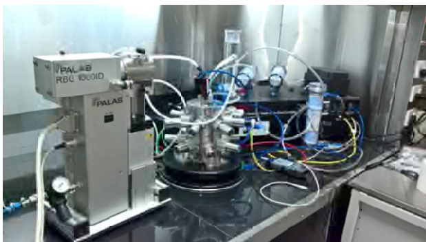
चित्र 2: केवल नाक इन्हेलेशन एक्सपोजर टावर इकाई (नोज ओन्ली इन्हेलेशन एक्सपोजर टावर), नियंत्रक इकाई, कैसकेड इंपेक्टर, फोटोमीटर आधारित पार्टिकल काउंटर, तापमान व आद्रता मीटर का रोटेटिंग ब्रुश डस्ट जेनेरेटर (पीएलएलएएस) द्वारा डस्ट ऐरोसोल्स पर अध्ययन का एक परिदृश्य
