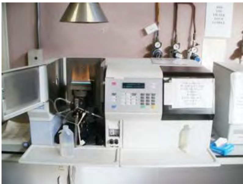
चित्र 1: परमाणु अवशोषण स्पेक्ट्रोमीटर
